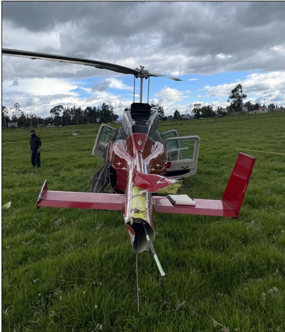
Fotografía No. 2 – Fractura del rotor de cola.
